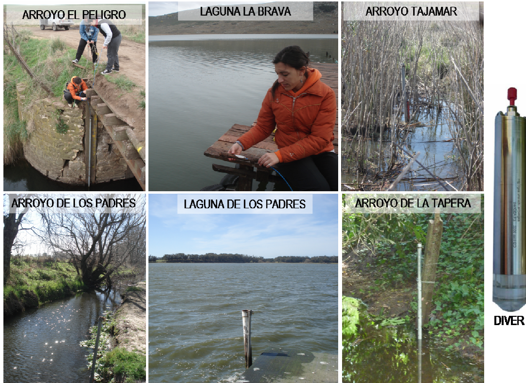
Figura 11.6 . Equipos de medición automática y registro continuo de variaciones del nivel, temperatura y conductividad eléctrica del agua en las lagunas y arroyos afluentes y efluentes a las mismas.
